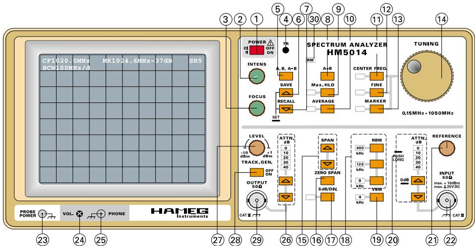
La LED RM indique que l'appareil est commandé à distance par le biais de son interface série. Il est impossible d'effectuer des réglages en face avant lorsque cette LED est allumée. Ce mode est annulé par une commande envoyée sur l'interface série ou en éteignant l'appareil. Le mode Commande à distance ne peut être activé que par une commande envoyée sur l'interface série.
