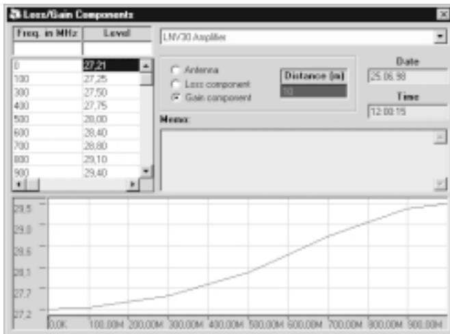
Il faut tout d'abord sélectionner le type de composant. Il peut s'agir d'une antenne (Antenna), d'un atténuateur (Loss component) ou d'un amplificateur (Gain component).
