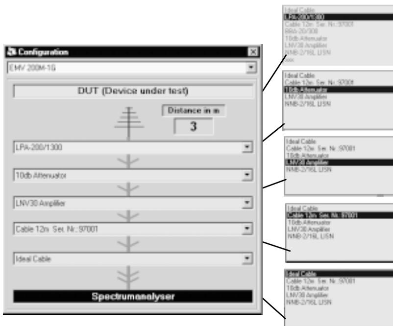
Le tracé du signal est simulé dans cette fenêtre, celui-ci se déplace de l'équipement à tester vers l'analyseur de spectre.
