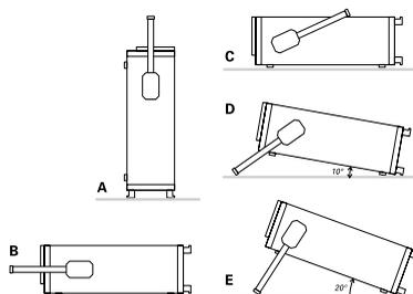
Pour travailler en position horizontale, tourner la poignée et la mettre en contact avec le capot de l'analyseur de spectre (C). Lorsque la poignée est verrouillée en position (D), l'appareil est incliné à 10°, et en position (E) à 20°.
