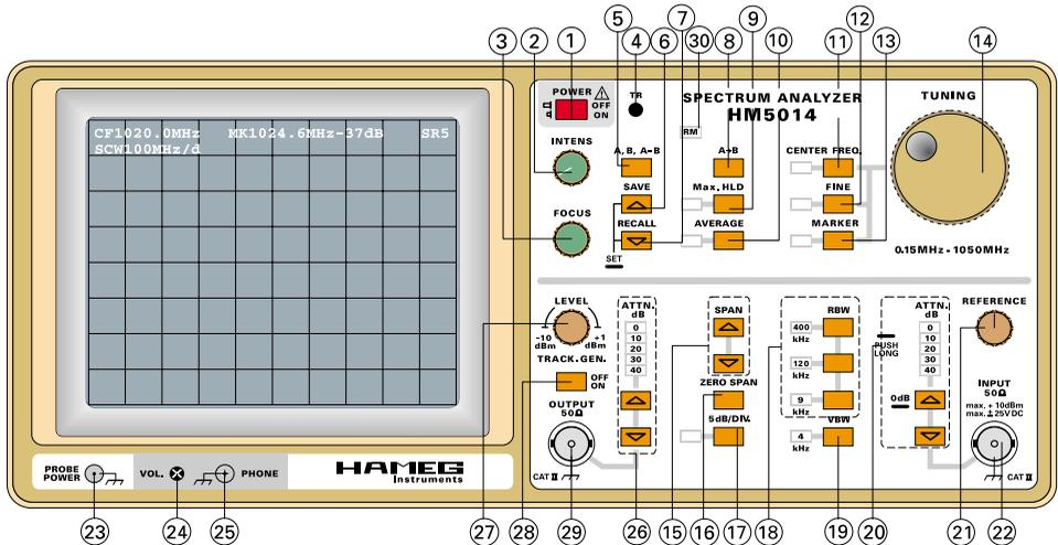
l'aide de la fréquence centrale (CENTER FREQ.). Le niveau mesuré est affiché par une ligne horizontale.
