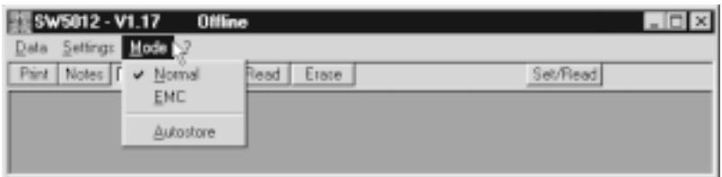
**Normal** Commande à distance de l'analyseur à partir du PC et collecte des données, traitement et enregistrement dans le PC.
