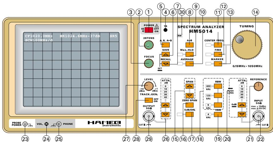
à l'aide du bouton (14). La fréquence réglée est affichée en haut à gauche de l'écran derrière la lettre C.
