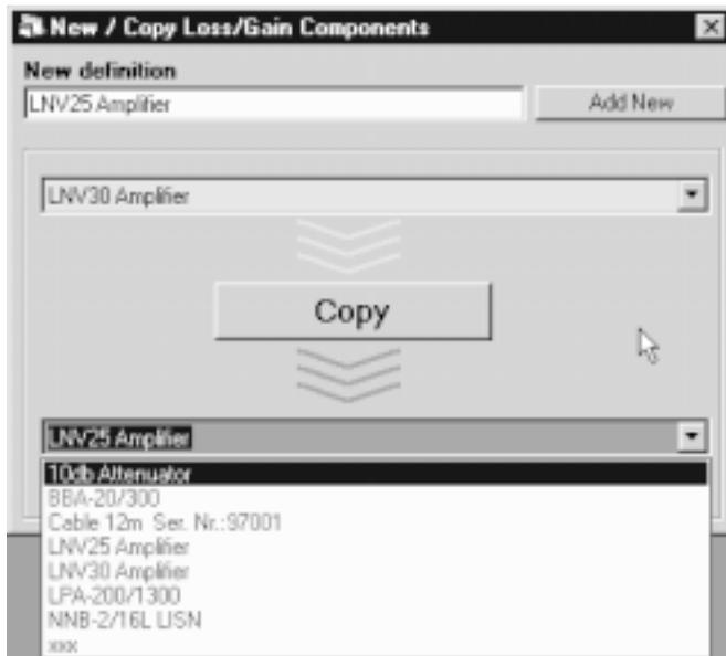
Les données d'un composant existant peuvent être copiées dans le nouveau composant à l'aide de la fonction **Copy**. Cette méthode est recommandée s'il n'existe que peu de différence entre les deux composants. L'étape suivante consiste, par exemple, à définir la réponse en fréquence d'un composant. Pour ce faire, cliquer sur **View Limitdefinition** ou, en variante, refermer la fenêtre et cliquer sur **Data, Edit, Loss/Gain-Components**. La fenêtre suivante apparaît alors :
